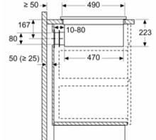
Al realizar la instalación directamente en paredes exteriores no aisladas ( $\mu \geq 0,5 \text{ W/m}^2 \cdot \text{C}$ ), recomendamos el uso de configuraciones de recirculación total o parcialmente canalizada.
