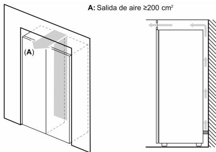
A: Salida de aire  $\geq 200 \text{ cm}^2$
